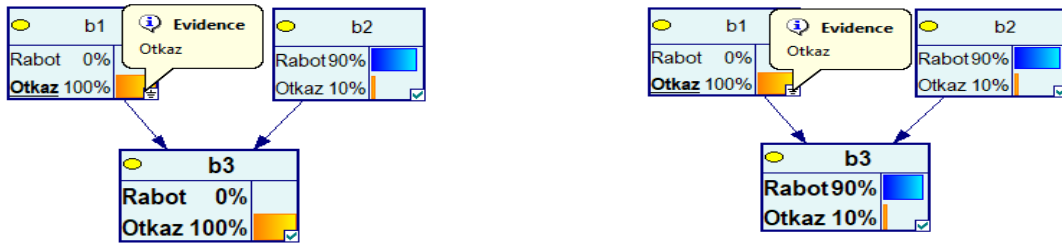
Рис. 5. Примеры апостериорного вывода в байесовских сетях при отказе одного элемента в блоках, содержащих два элемента соединенных: а) последовательно; б) параллельно
