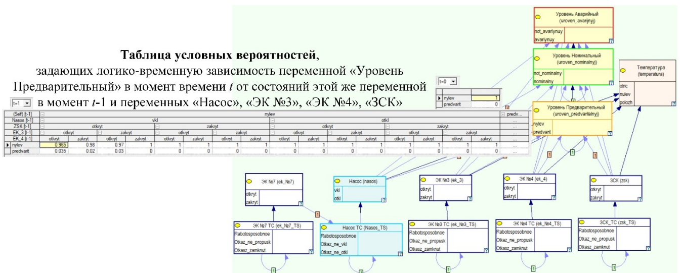
Рис. 9. Фрагмент байесовской сети, связывающей контролируемый признак «Уровень Предварительный» с состоянием технологического оборудования
