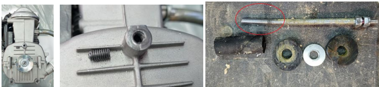
Рисунок 5 – Обрыв несущей шпильки, кусок шпильки, извлеченный из двигателя
