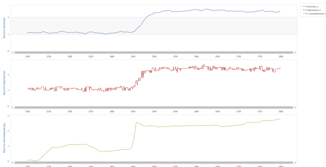
Рисунок 8. Показания высоты при выводе микроБЛА на высоту 2.5 метра
