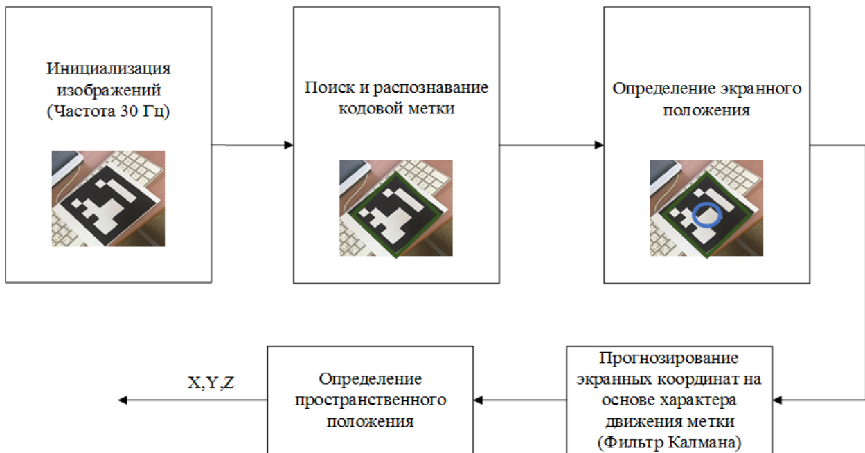
Рисунок 4. Схема работы системы визуальной навигации
