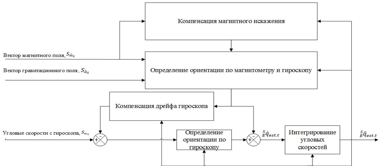
Рисунок 3. Схема работы фильтра Махони.
