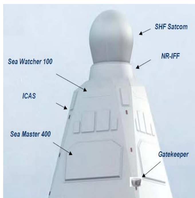
Рисунок 1 — примеры реализации вертикальной схемы размещения антенных постов: а – размещение АП на отдельной несущей мачте [10], б – интегрированная мачта Thales I-Mast 400 [11].
