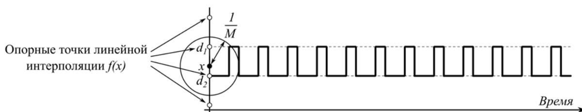
Рис. 2. Иллюстрация диапазона возможных значений выходного сигнала усредняющего фильтра  $D_{y\phi}(X_M)$
