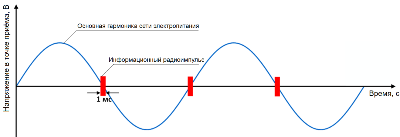
Рисунок 3 – принцип синхронного формирования сигнала стандарта X10
