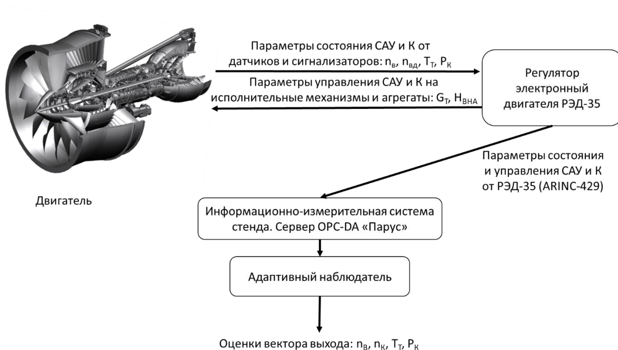
Рисунок 3. Блок-схема управления ДДТ-35 и формирования расчетных оценок адаптивным наблюдателем
