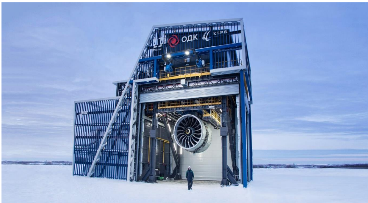
Рисунок 2. Двигатель-демонстратор технологий на открытом испытательном стенде (д. Фролы, г. Пермь)
