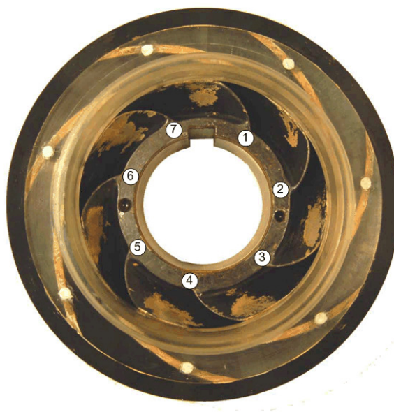
Рис. 1. Разрушения лака в модельном рабочем колесе по данным [1]
