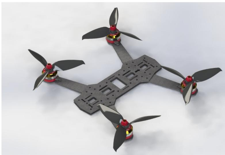
Рисунок 1 – Визуализация трехмерной модели квадрокоптера в CAD-системе
