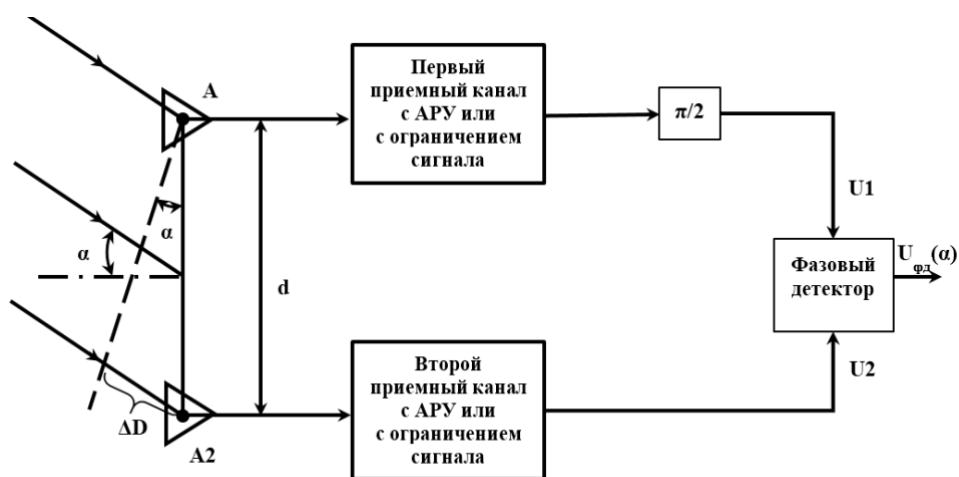
Рисунок 3 – Принцип работы фазовых методов пеленгации
