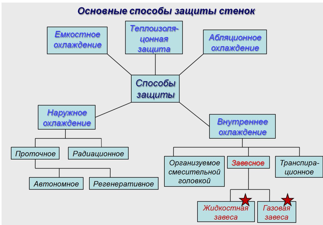
Рис.1. Классификация способов охлаждения стенок камеры и сопла ЖРД МТ. [2]
