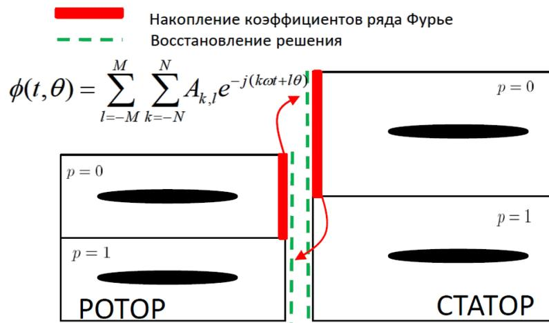
Рисунок 6 – Преобразования Фурье на межвенечном интерфейсе
