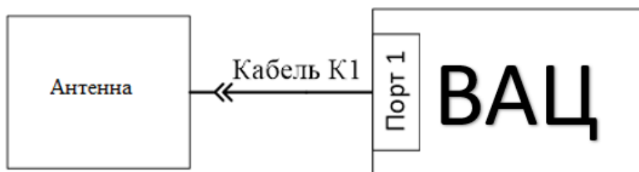
Рисунок 4 – Схема измерения коэффициента отражения
