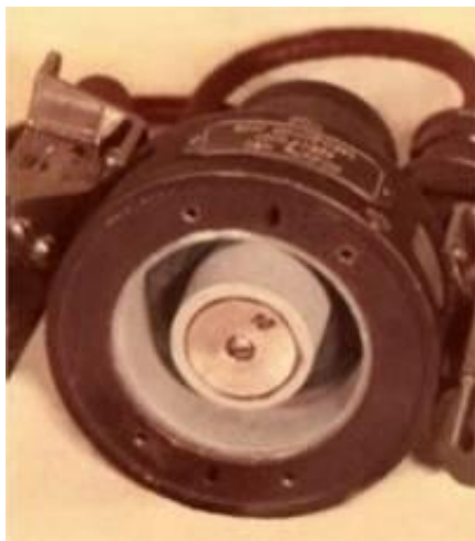
Рисунок 1 - Стационарный плазменный двигатель М-50 с круглой МС с одной общей наружной катушкой
