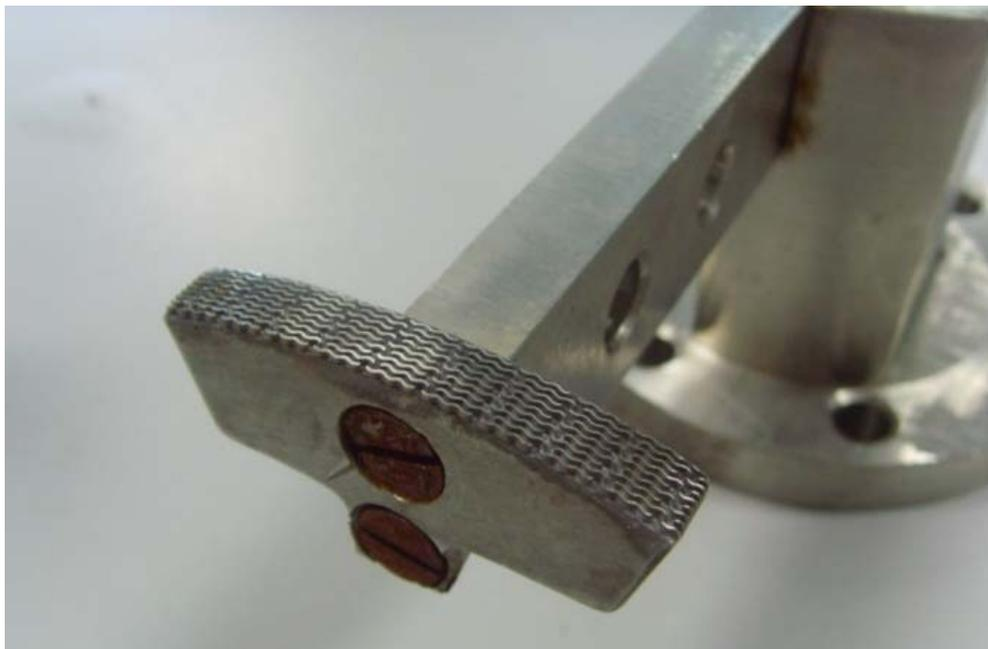
Рис. 12. Специальный ЭИ с зигзагообразными выступами для нанесения рельефа методом импульсной ЭХО
