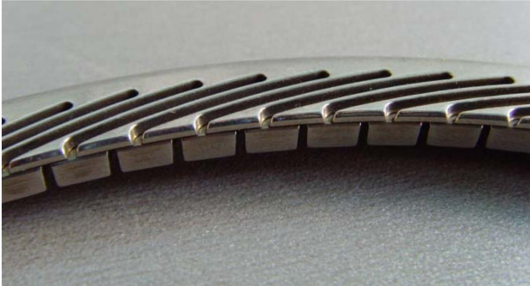
Рис. 11. Компактное пальчиковое уплотнение (материал: сталь 10X11H23T3MP, посадочный диаметр: 160 мм, внешний диаметр: 182 мм, количество пазов: 90 шт.)
