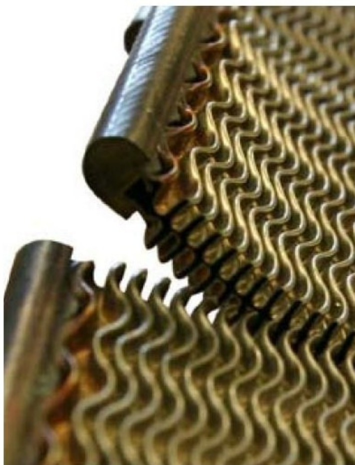
Рис. 14. Конструкция рекуператора ГТУ Capstone C-30, C-60, C-65, C-200
