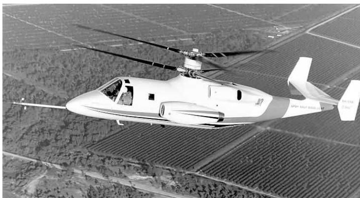
Рис. 6. Вертолет *S-69* двумя турбореактивными двигателями *Pratt & Whitney J60-P-3A*
