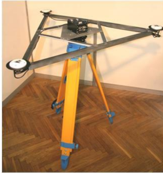
Рисунок 3 – Комплекс в сборе с тремя ГНСС антеннами
