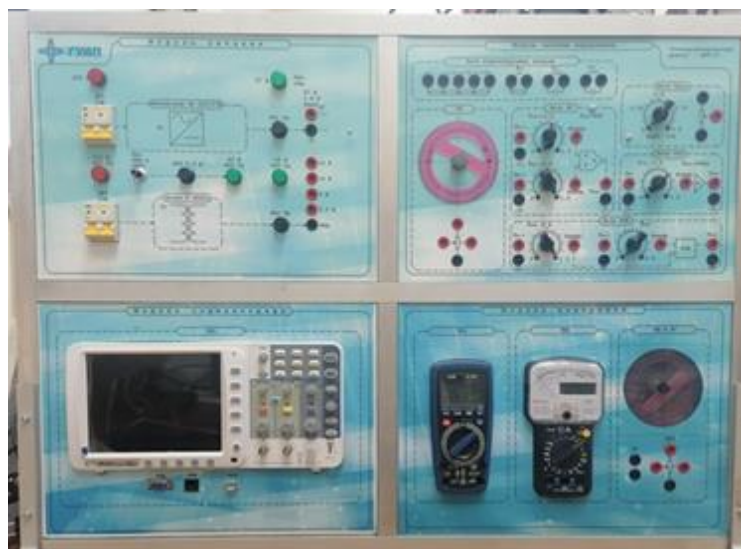
Рисунок 1 - Общий вид учебно-исследовательского стенда «Потенциометрическая маломощная следящая система»
