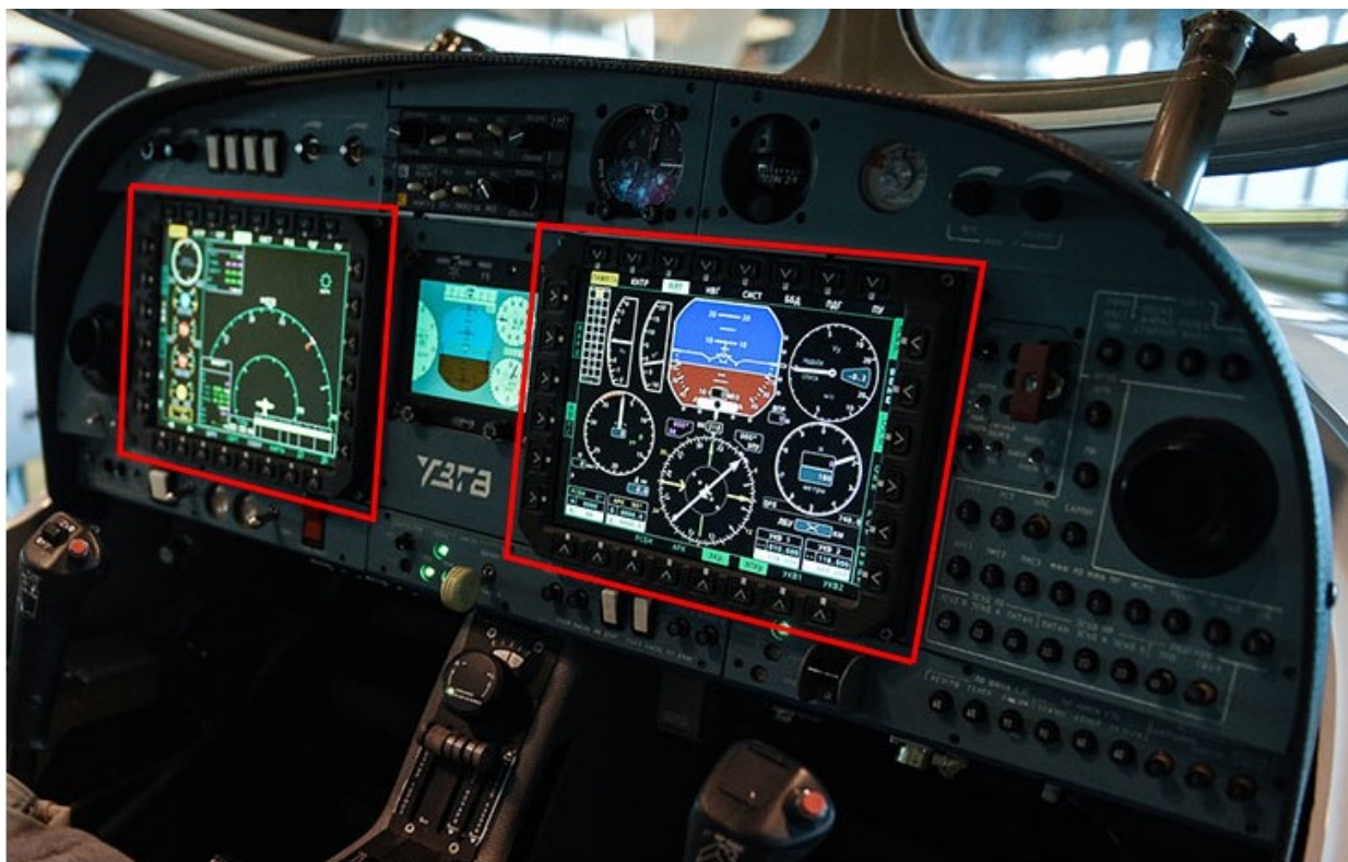
Рисунок 1 – Многофункциональные индикаторы на приборной панели самолёта ДА-42Т
