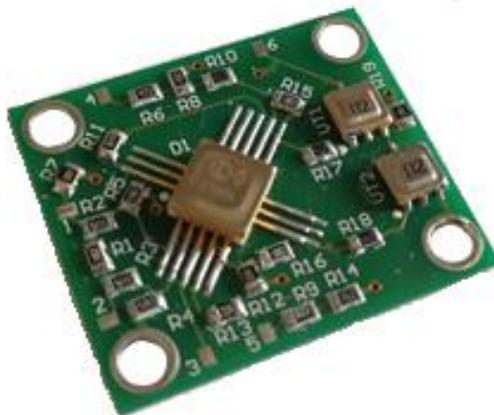
Рисунок 7 – Плата устройства защиты от дозового воздействия
