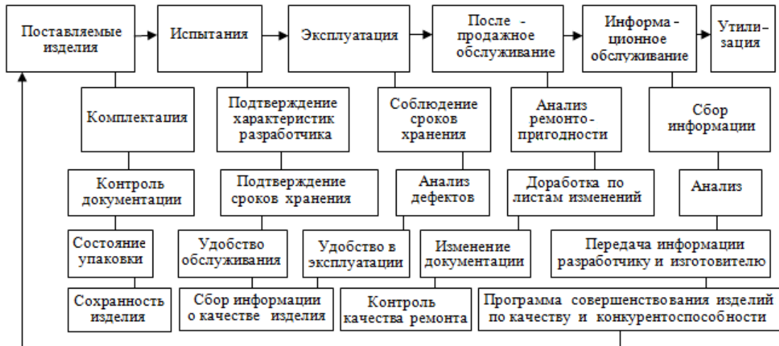
Рис. 1. Структурно-функциональная схема управления обеспечением качества и конкурентоспособности изделия на этапах испытаний, эксплуатации и послепродажного обслуживания
