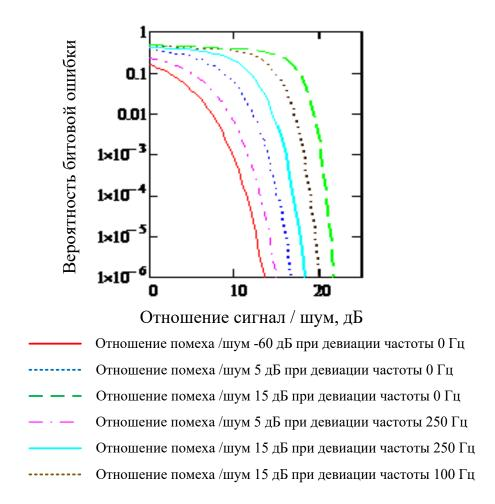
Рис. 1. Зависимость вероятности ошибки приема бита от отношения сигнал/шум
