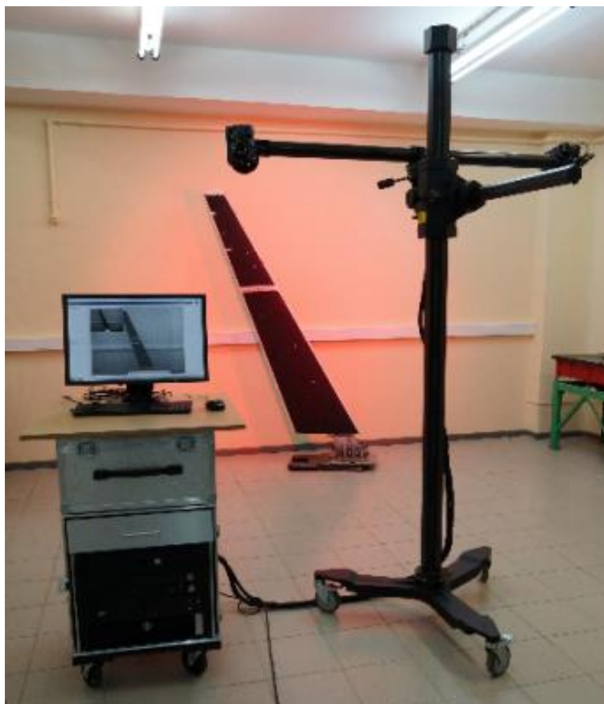
Рисунок 10. Фотограмметрическая система ARAMIS 3D 12M
