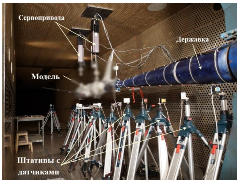
Рисунок 5. Принципиальная схема реализации СЖИ на модели самолета при измерении её параметров жесткости в рабочей части АДТ
