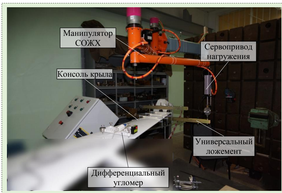
Рисунок 8. Консоль крыла при испытаниях по определению распределения балочных жесткостей
