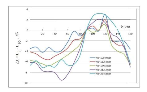
Рисунок 6 – Нормализованная характеристика направленности акустического излучения самолета Як-18Т в статических условиях
