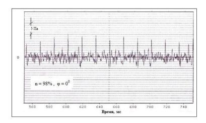
Рисунок 4 — Временная реализация звукового давления в ближнем акустическом поле винта самолета Як-18T
