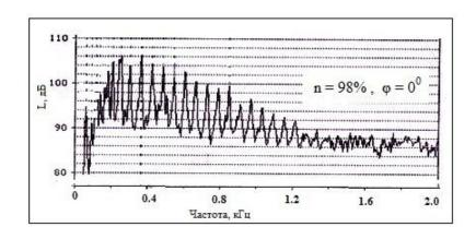
Рисунок 5 – Спектр уровней звукового давления в ближнем поле винта самолета Як-18Т
