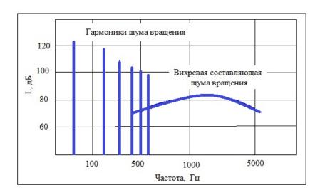
Рис. 2 Типичный спектр шума воздушного винта
