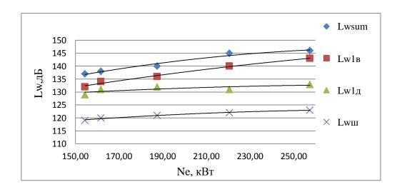
Рисунок 76 - Зависимость мощности акустического излучения от мощности СУ
