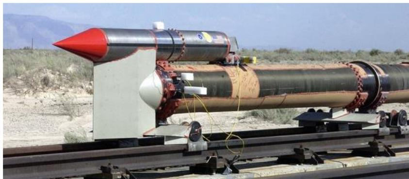
Рис. 1. Рельсовый снаряд – рекордсмен скорости для ракетных кареток.
