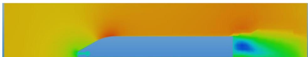
Рис.11. Характерное поле скоростей обтекания головного вагона ВСП
