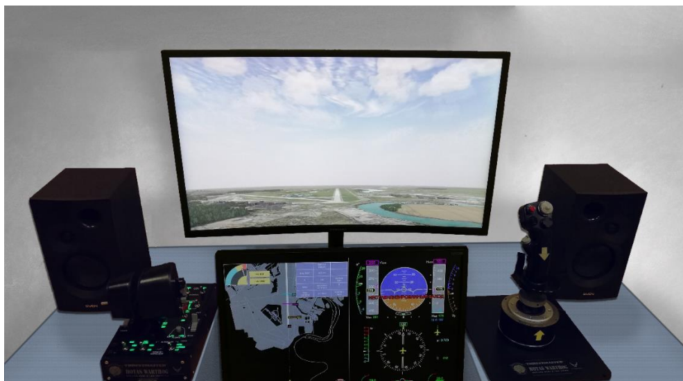
Рис. 10. Стенд-демонстратор бортовой системы ситуационной осведомленности экипажа.
