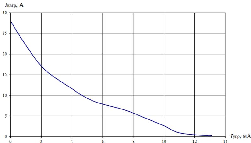
Рис.5. Регулировочная характеристика модели 3Ф6П-МРВУ с ОДН во вторичной цепи, с LC-фильтром
