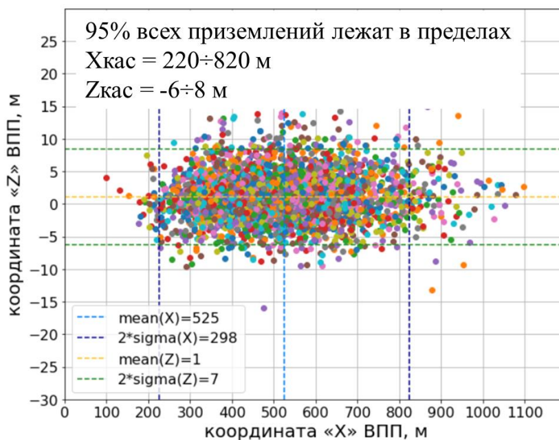
Рис. 10 – Диаграмма рассеяния точек приземления самолета на ВПП
