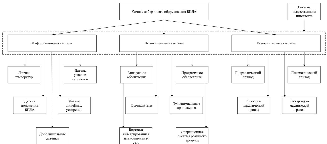
Рис. 7. Структурная схема комплекса бортового оборудования БПЛА с системой искусственного интеллекта
