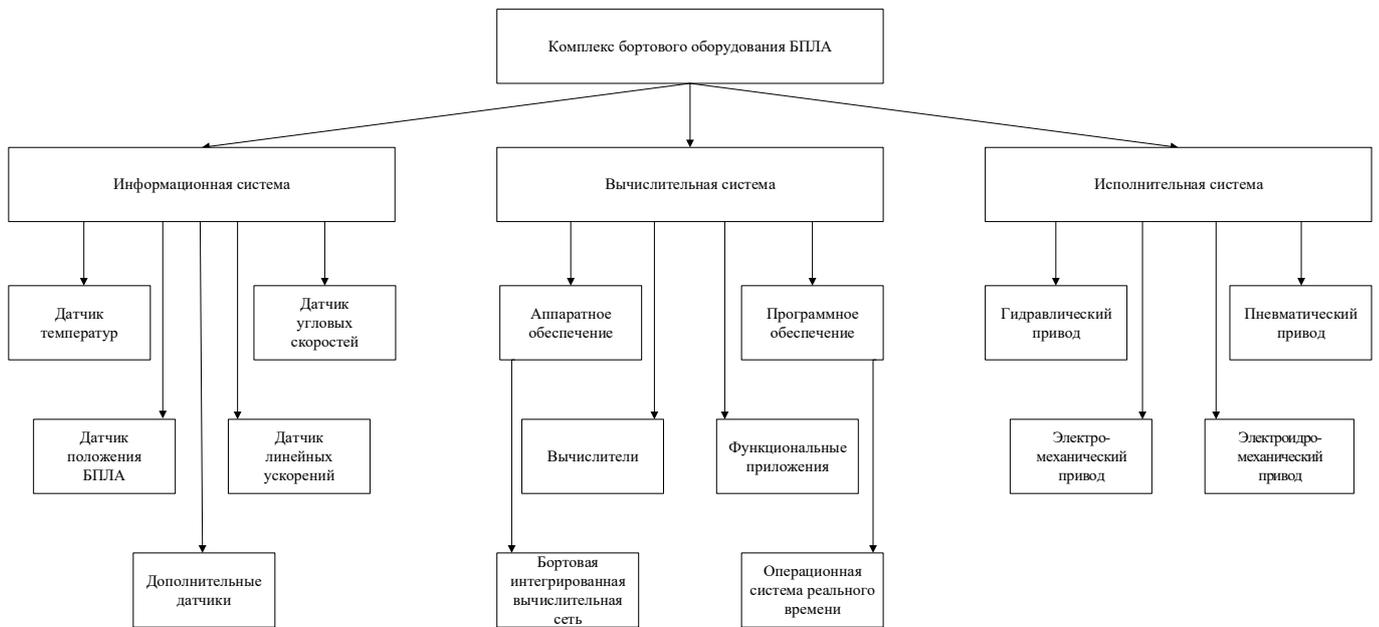
Рис. 1. Типовая структурная схема комплекса бортового оборудования БПЛА
