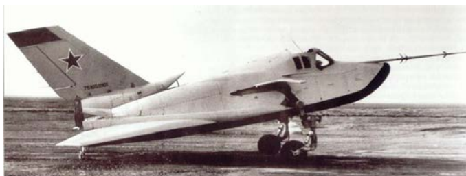
Рис. 11. Аналог для атмосферных испытаний орбитальной самолета системы «Спираль»
