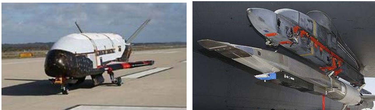
Рис. 2. Технологии США: многоразовый беспилотный орбитальный самолет X-37В (слева) и крылатая ракета больших сверхзвуковых скоростей с ПВРД X-51 (справа)
