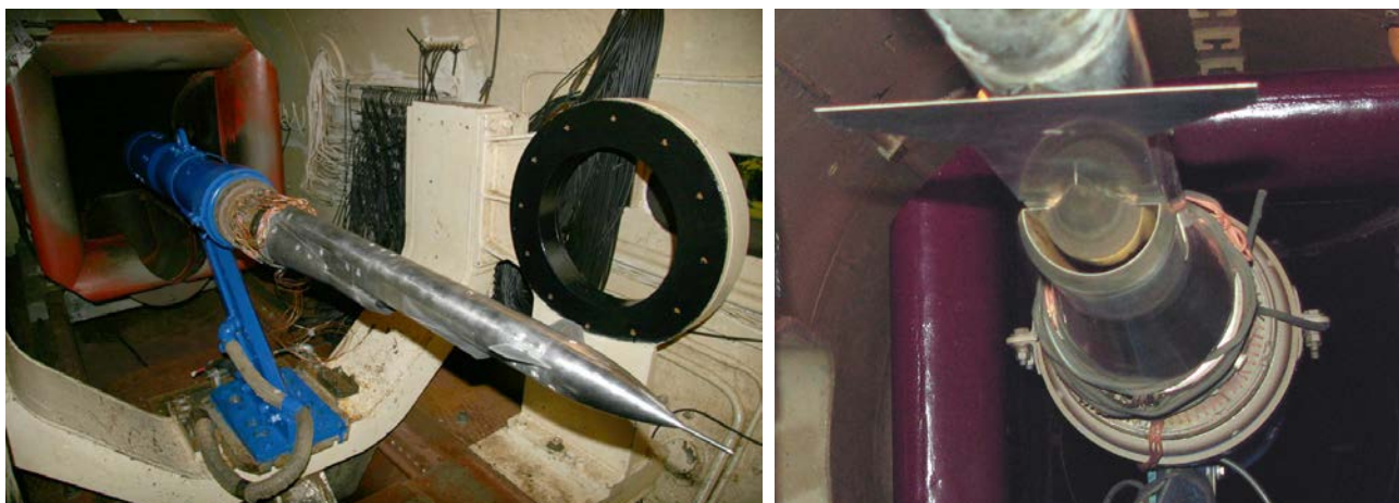
Рис. 8. Испытания модели экранного воздухозаборного устройства прототипа на установке СВС-2-ЦАГИ, 2009 – 2010 г.
