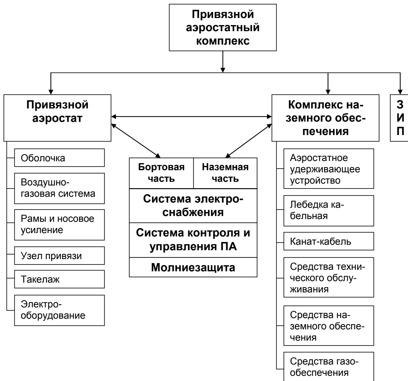
Рисунок 1. Структурная схема привязного аэростатного комплекса.
