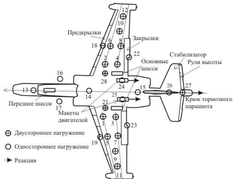
Рис. 2 - Схема каналов нагружения на основной полетный случай нагружения
