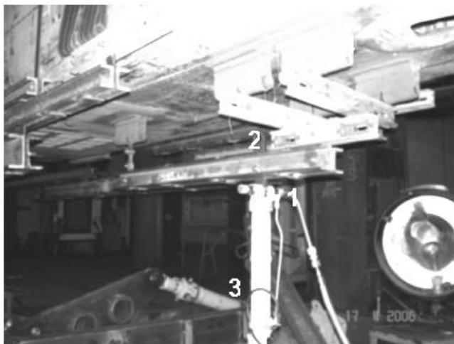
Рис. 14 – Нагружающее устройство передней опоры шасси
