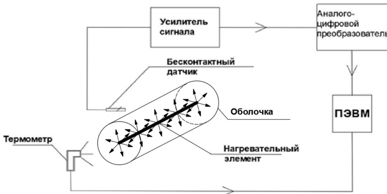
Рисунок 2. Схеме экспериментального стенда.
