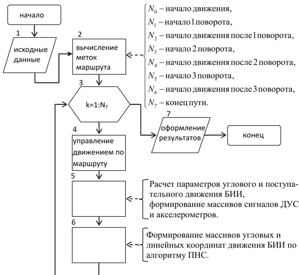
Рис. 5. Блок - схема алгоритма моделирования движения робота
