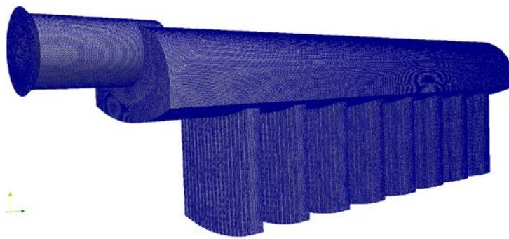
б) общий вид коллектора с расчетной сеткой
