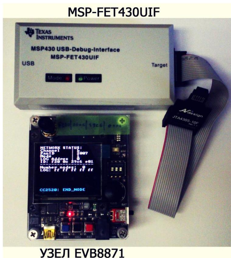
Рисунок 1. Узел (внизу) и программатор (вверху).
