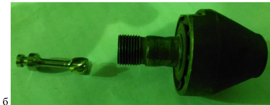
Рис. 2 Фото форсунки а) Струйная форсунка СГФ б) форсунка с подачей закрученной топливной струи ЦБГФ
