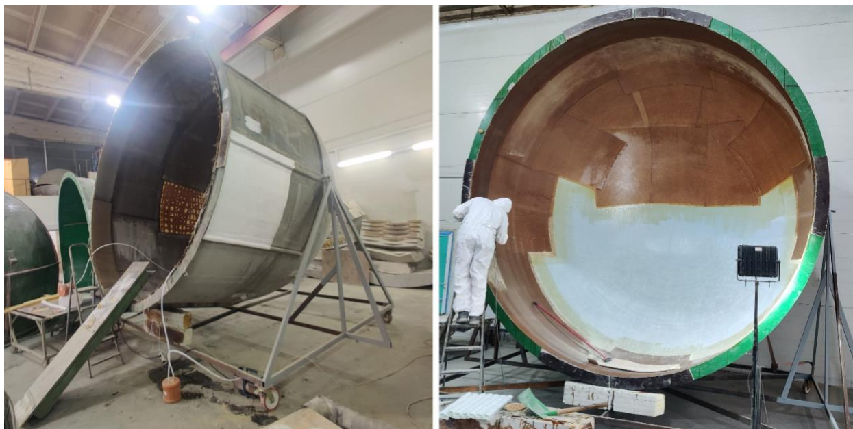
Рис. 14. Матрица для изготовления обтекателей
