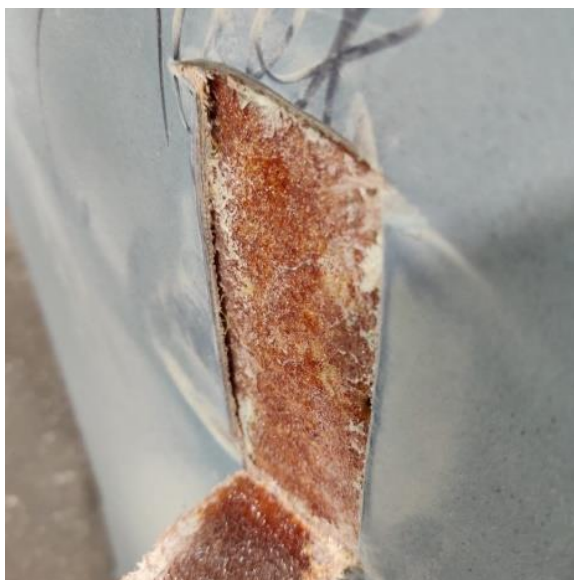
Рис. 10. Фотография обнаруженного дефекта (отслоение обшивки стенки обтекателя)
