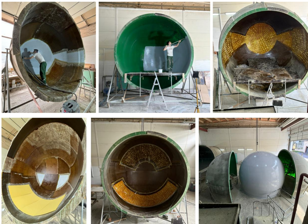
Рис. 2. Этапы технологического процесса изготовления крупногабаритных РПУ.
