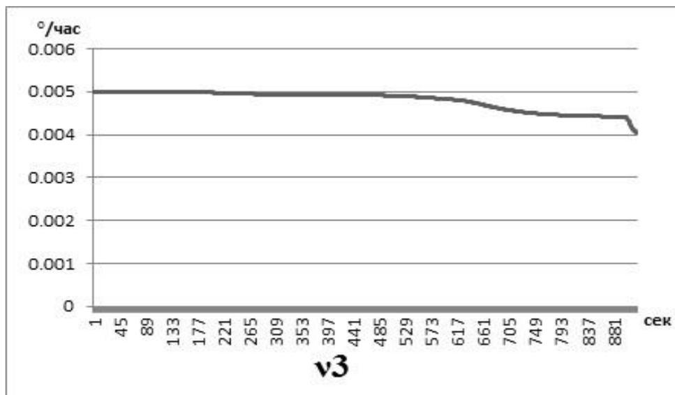
Для оценивания эффективности использования оценок, полученных в процессе рулежки и разгона, производилось моделирование алгоритмов автономной навигации с учетом компенсации оцененных инструментальных, угловых погрешностей и без компенсации. Имитируемая траектория состояла из прямолинейных участков и поворотов. Моделировался полет самолета в течение 1 часа. Критерием качества осуществленной докалибровки БИНС была выбрана величина
