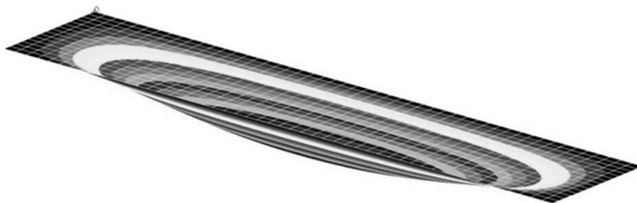
Рис 1.1. Результат численного расчета пластины на собственные формы колебаний при 1-й собственной частоте ( p=160.94 Гц).
