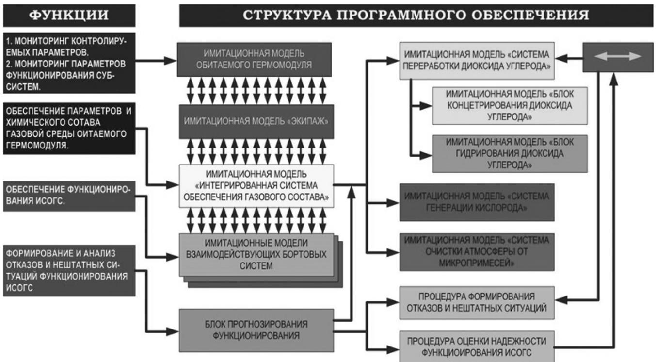
Рис. 3. Функции и структура программного обеспечения
