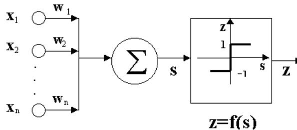
Структурная схема функционирования одного нейрона.
