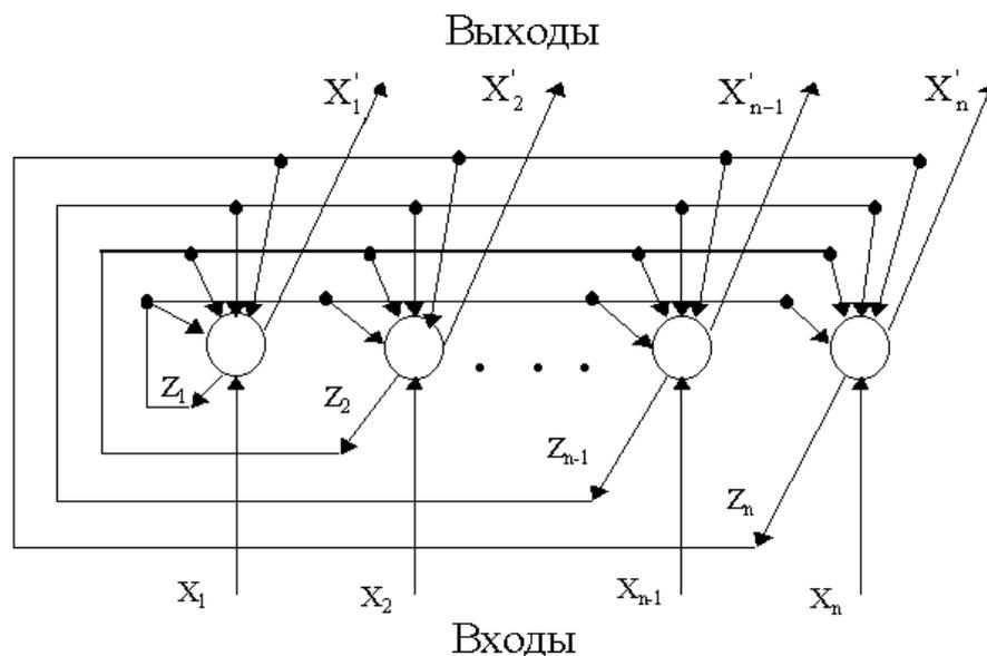
Структурная схема функционирования сети Хопфилда.
