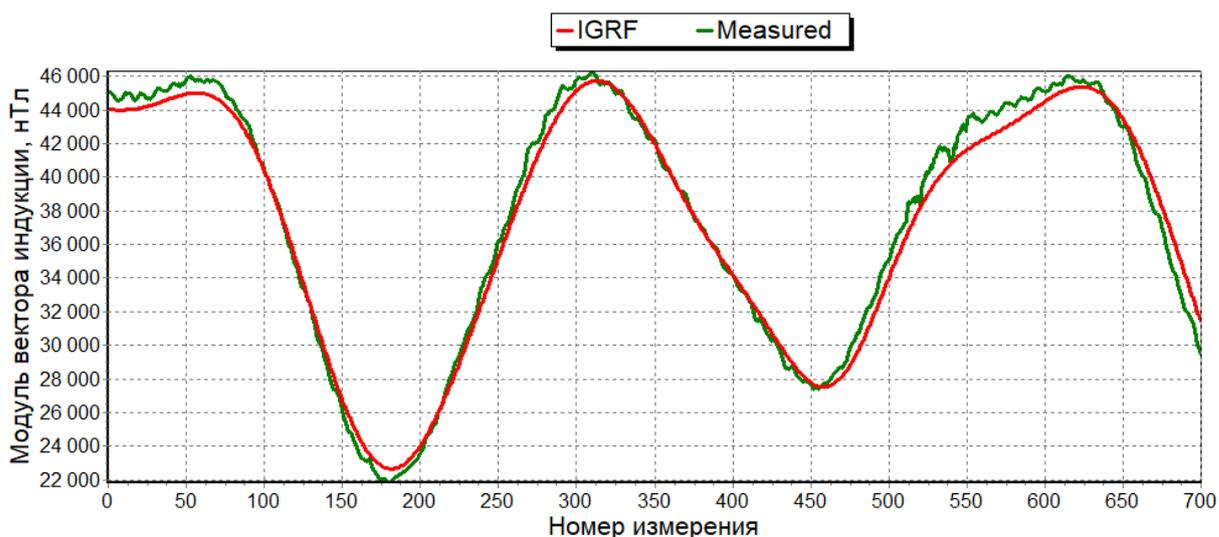
Рисунок 2. График изменения измеренного и модельного модуля вектора магнитной индукции после калибровки
