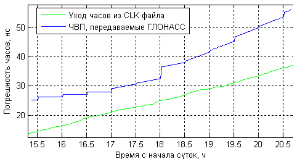
Рис. 2. Сдвиг шкалы времени КА ГЛОНАСС №22 относительно системного времени
