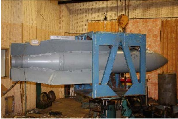
Рис.2. Установка АБ с крепежным приспособлением на платформе вибростенда
