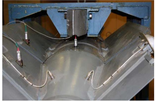
Рис.3. Установка вибропреобразователей на изделие
