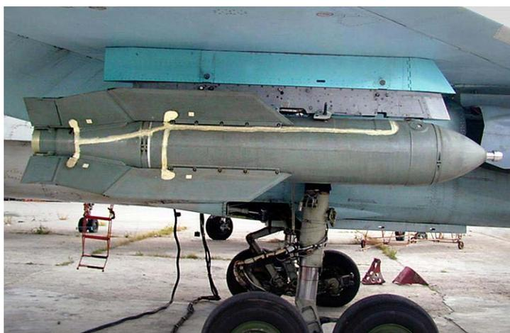
*Рис. 1. Авиационная бомба на внешней подвеске носителя*
