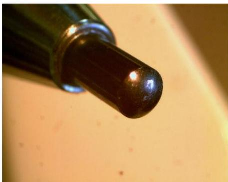
Рис. 5. Цилиндрическая шейка вала ротора осевого насоса
