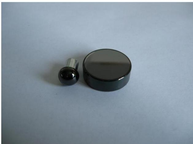
Рис. 3. Образцы из сплава CoCrMo с нанесенным алмазоподобным покрытием
