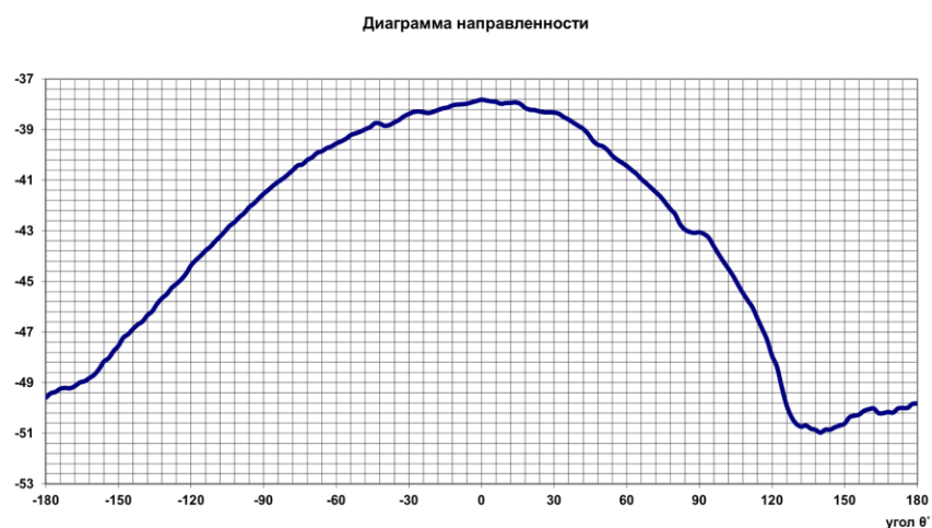
Рис. 13. Ненормированная ДН макета МПА КА «CubeSat»
