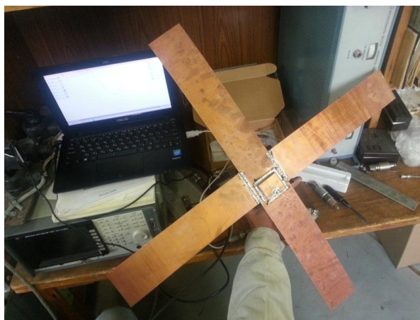
Рис. 11. Фото антенного макета сверхмалого КА «CubeSat» формата 1U с МПА 435 МГц
