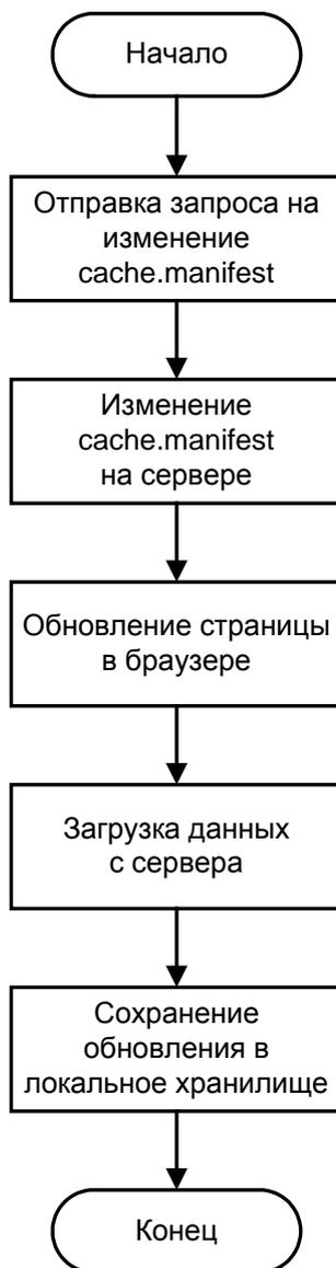
Рис. 5. Схема работа контроллера обновления манифеста кэша на стороне клиента и серверного актуализатора манифеста кэша
