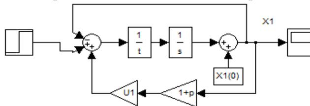
Рис.1 Математическая модель производственного звена
